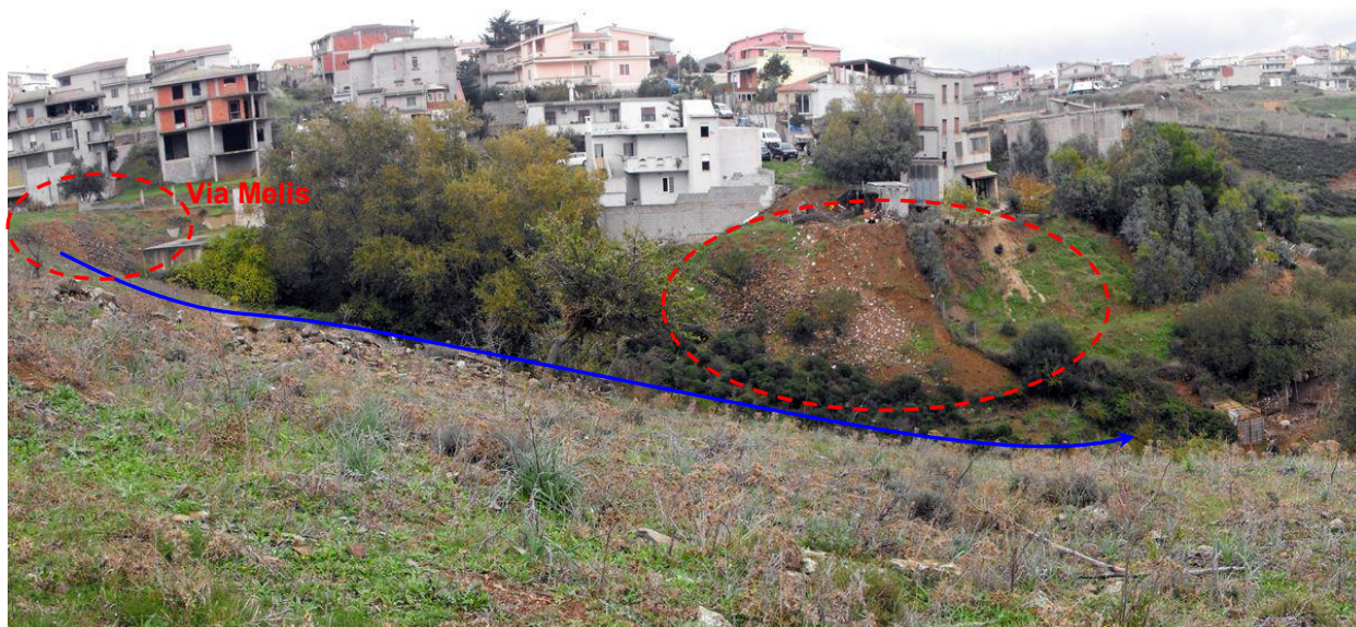
Figura 21. Impluvio a valle della via G.B. Melis: negli ovali in rosso sono evidenziate le aree di riporto e/o dilavamento lungo la sponda sinistra.
