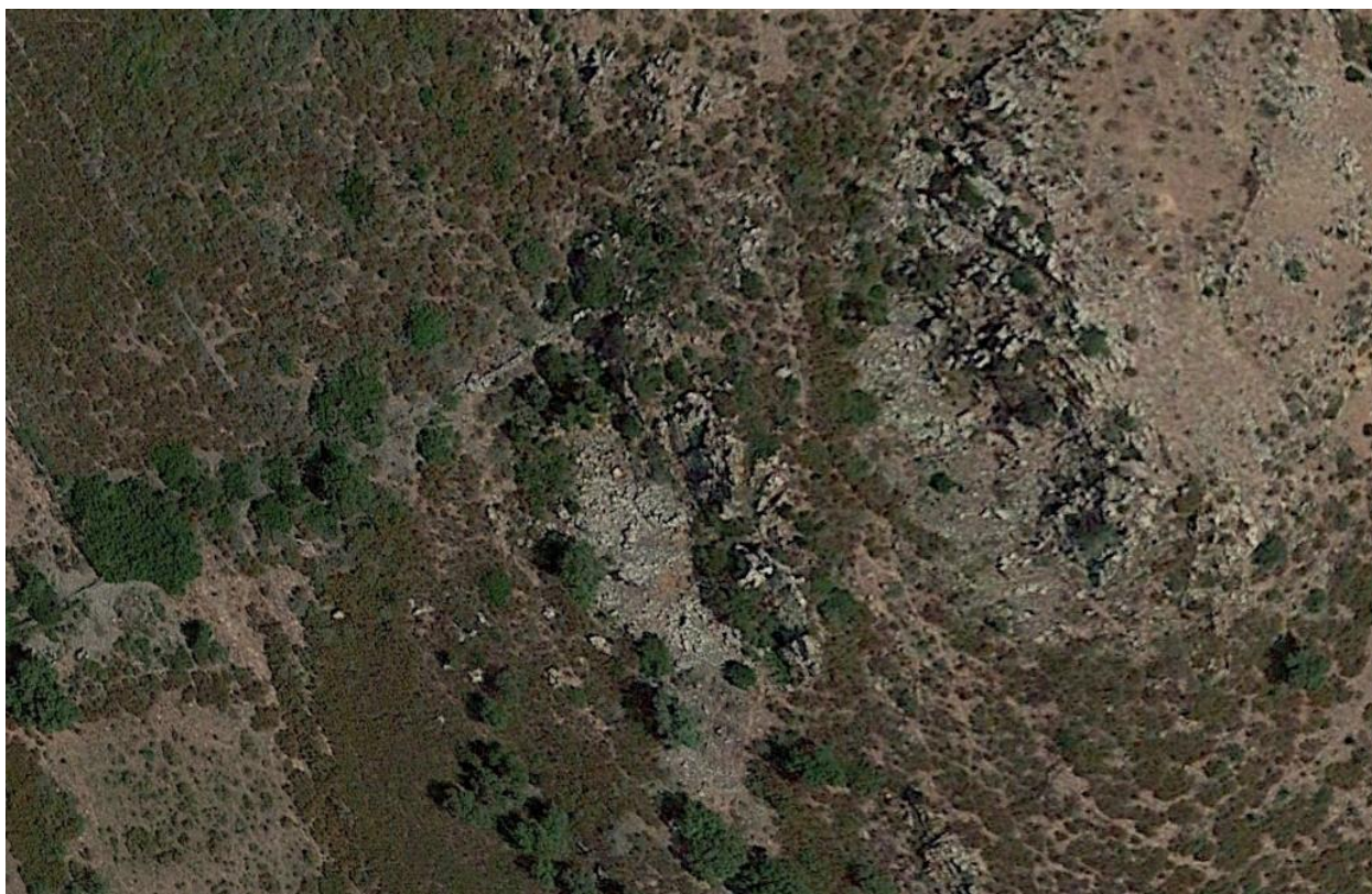
Figura 33. Vista Aerea (Google Earth, 2015) dello spuntone roccioso che domina il versante a valle della viabilità comunale, in località Su Moddizzi: si osservano numerosi blocchi derivanti da distacchi, arrestatisi a mezza costa e potenzialmente rimobilizzabili.
