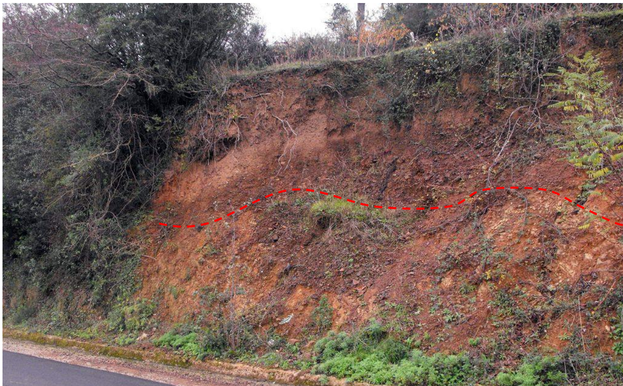
Figura 24. Nicchia relativa allo smottamento in Fig.23: il tratteggio in rosso segna il contatto tra coltre eluvio-colluviale e ammasso roccioso alterato.
